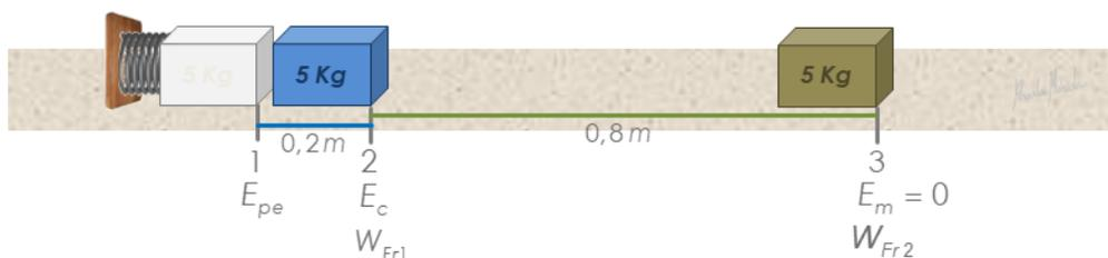
**Segundo tramo.** De posición 2 a posición 3, hay un desplazamiento de 0,8m. Aplica la ecuación de trabajo y energía.
